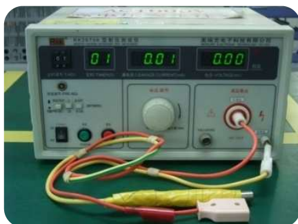
高電耐压試験器
